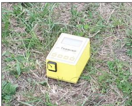
Tromometro digitale Moho s.p.a. modello "Tromino - zero 3g".
