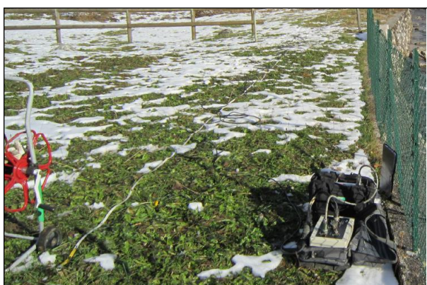
Georesistivimetro Abem mod. Terrameter SAS 1000 a 64 elettrodi.
